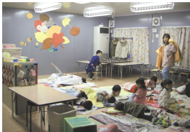
■仮設園舎：ボールがあたっても蛍光灯が破損しないよう、安全カバーを取り付けてあります
