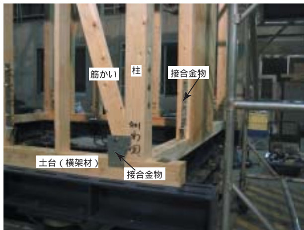
接合金物の仕様が明確化されました(実験時の写真)
