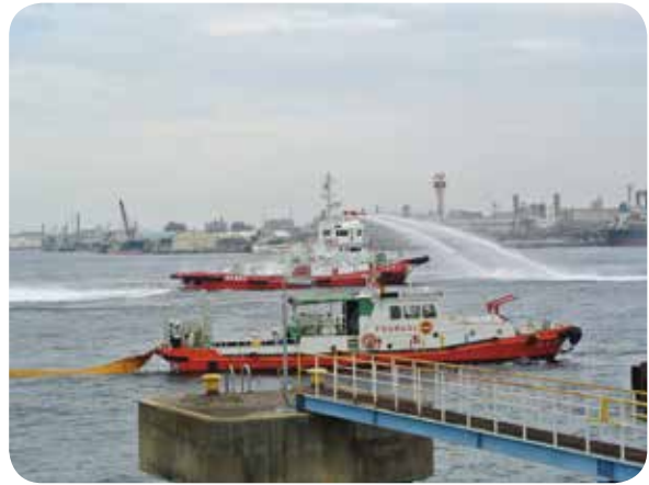
消防艇などにより行われた、海面へのオイルフェンスの展張や放水の訓練
