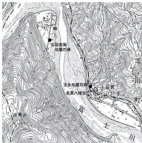
図1 安政東海地震（1854）による白鳥山東側斜面崩壊による富士川閉塞地点
