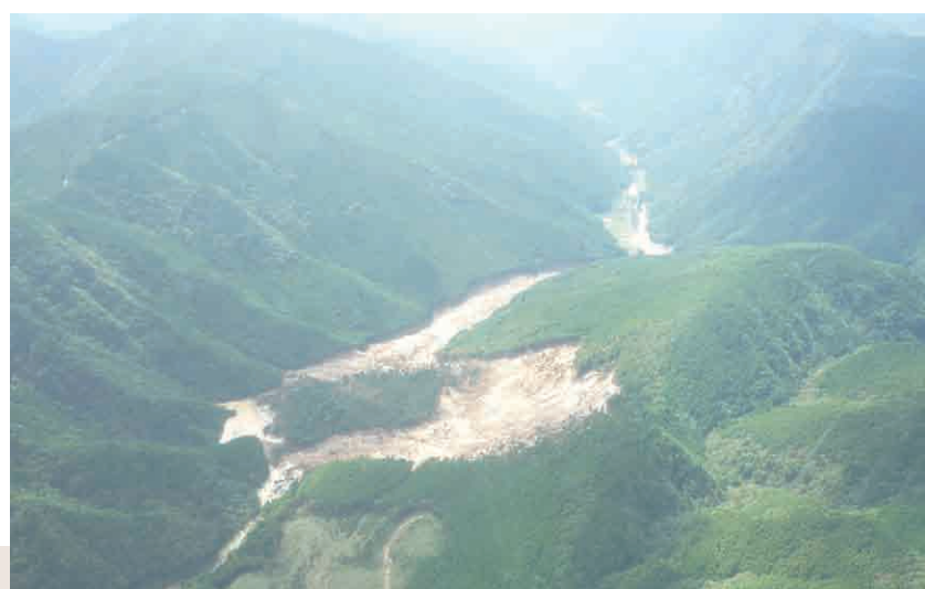
台風12号によって崩れた土砂が川を堰き止めてできた河道閉塞 （和歌山県田辺市熊野）
