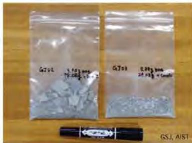
写真6 乾燥させた火山灰試料(30cm四方で採取、大きな塊は乾燥時に表面で固まった粘土)。火山口から北東2.8km付近の降灰主軸あたりでは823g/m<sup>2</sup>(GJ02)の値を得た。
