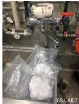
写真5 一定面積の火山灰試料は雪とともに持ち帰ったため、雪を溶かして乾燥させ秤量する。
