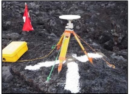
三角点設置後のGNSS測量 (白いペンキは対空標識)
