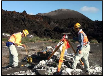
三角点設置後のGNSS測量 (背景は最も高い火砕丘)
