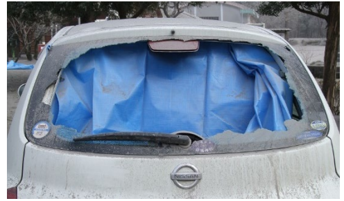
霧島山：小さな噴石によって破損した車のリアガラス
