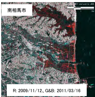
赤色、水色の箇所が2時期の変化箇所 赤色：浸水・湛水域が主体 水色：浸水・湛水やその他の変化
