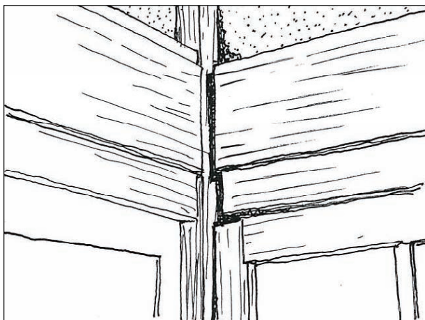
柱と梁の仕口にずれが生じている。
