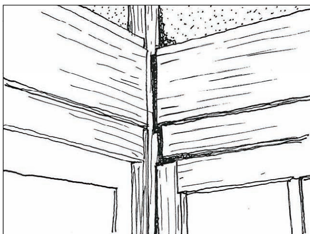
柱と梁の仕口にずれが生じている。
