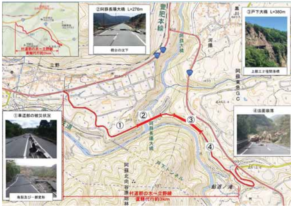
図 村道栃の木～立野線の被災状況
