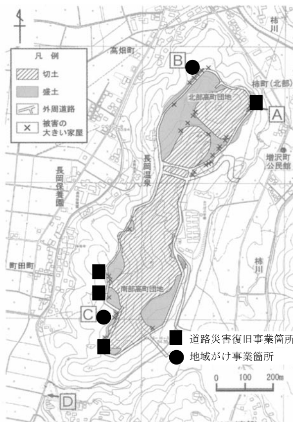
図 3.3 切土部と盛土部の位置と被害状況(文献5)に事業箇所を加筆
