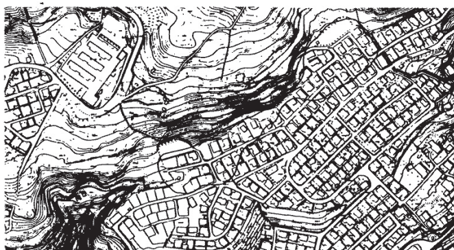
▲被災状況 (黒太線内は崩壊土砂により埋没した部分)
