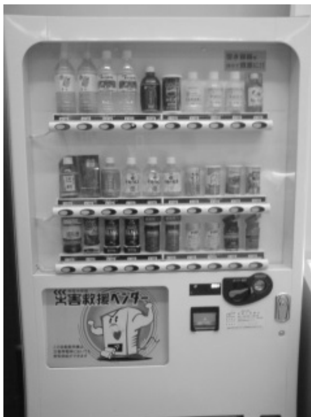
写真 16-3 災害時対応自動販売機の例
