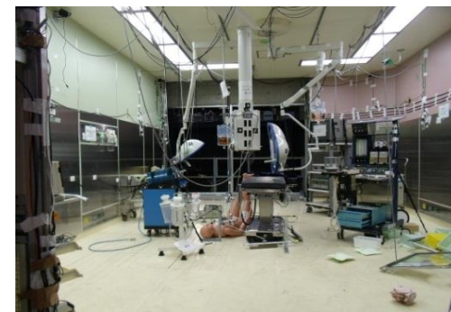
加振実験後の室内状況 (上:免震/下:耐震)
