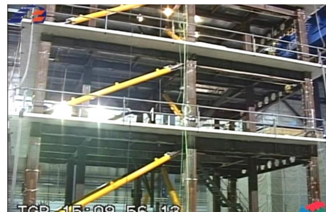
ブレース鋼製ダンパー(黄色部) →エネルギー吸収
