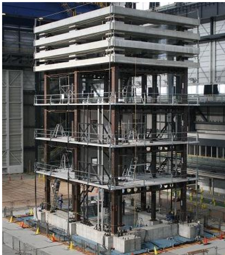
高層建物を模擬した骨組み試験体
