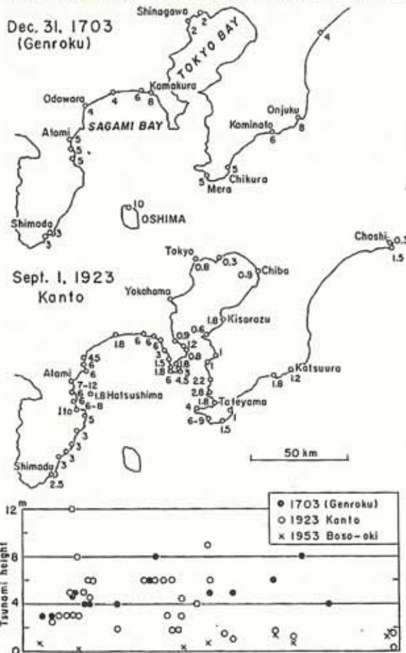
図 1703 年元禄地震、1923 年関東地震および 1953 年房総沖地震の津波高さの比較図 (羽鳥・他 (1973))
