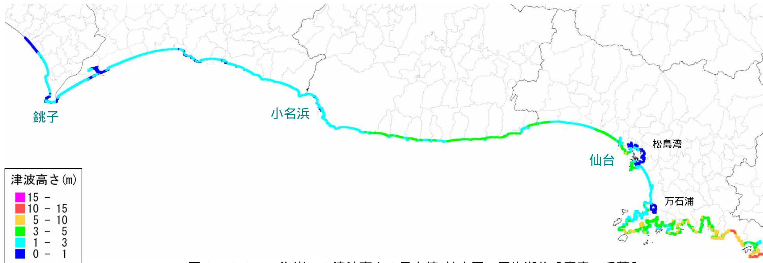
図4 - 1 1 海岸での津波高さの最大値 拡大図：平均潮位【青森～千葉】
