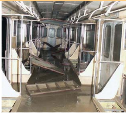
地下に流入した氾濫水により壊れた地下鉄車両 (平成14年:ブラハ)
