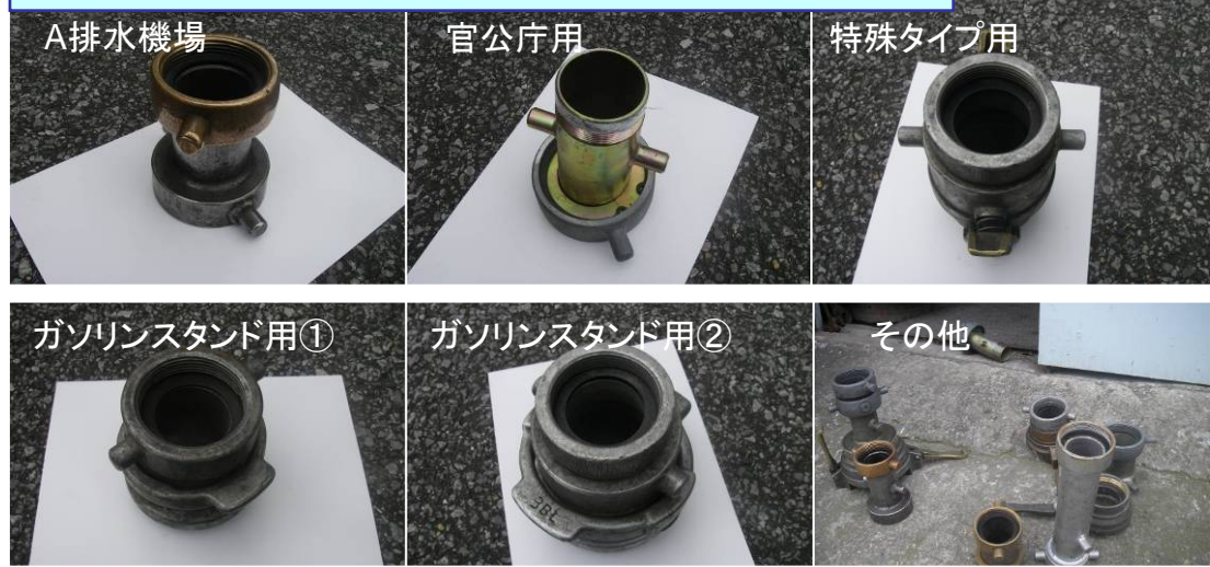
施設によって給油口の金具が異なる(アタッチメント)
