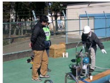
図 3-1-1 防災井戸と浄水器 (左)、プールの水のろ過 (右) による水の確保
