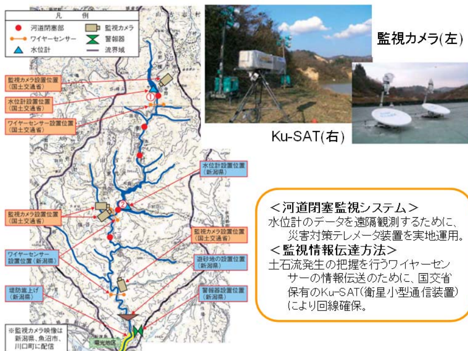
図 5-8-1 新潟県中越地震における監視体制(モニタリングシステム)
