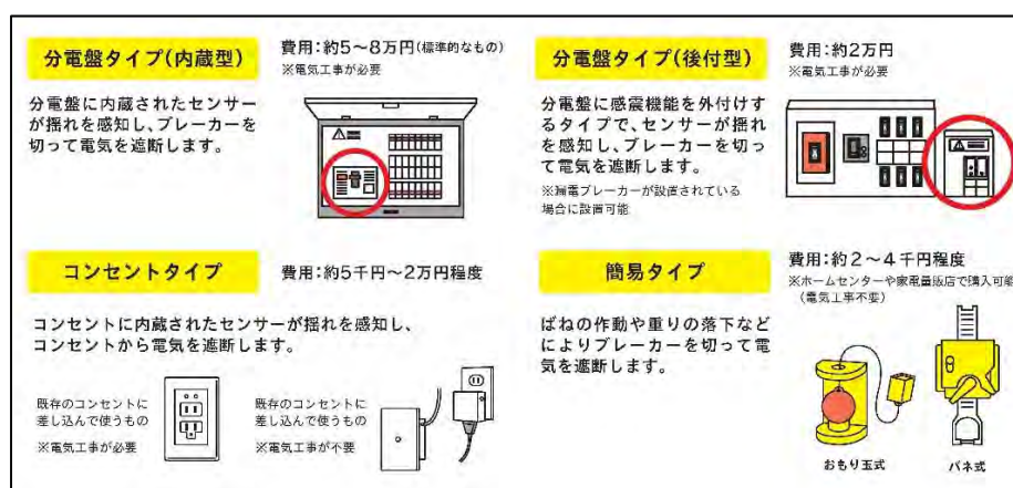
図 3-1 感震ブレーカーの種類
