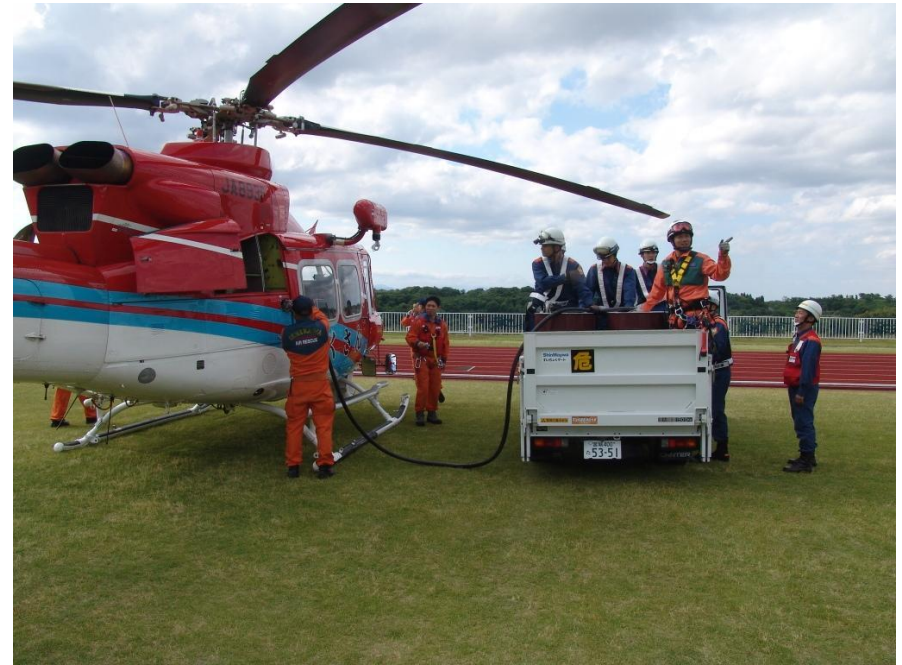
築館臨時ヘリポートにおけるドラム缶からの給油作業
