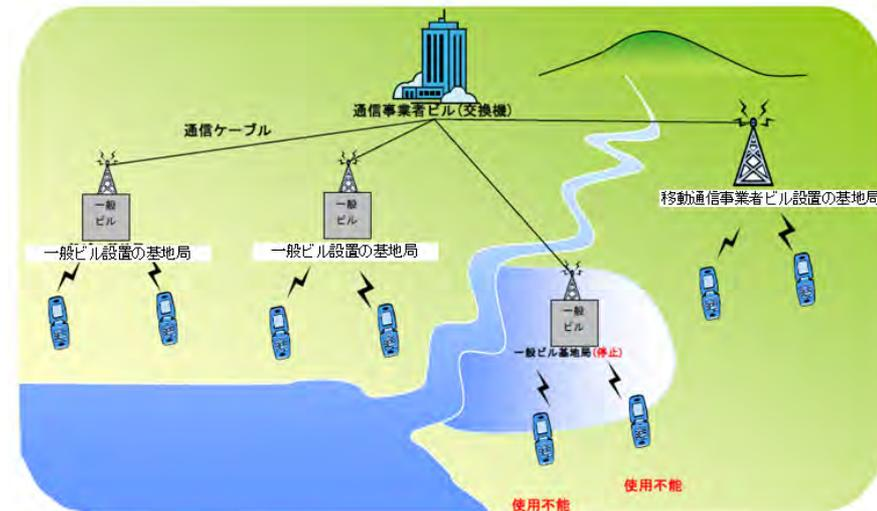
浸水による携帯電話への影響概念図(一部加筆)
