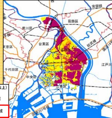
※荒川右岸10.25kmが破堤した場合において、一定の条件を考慮のうえ算出したシミュレーション結果
