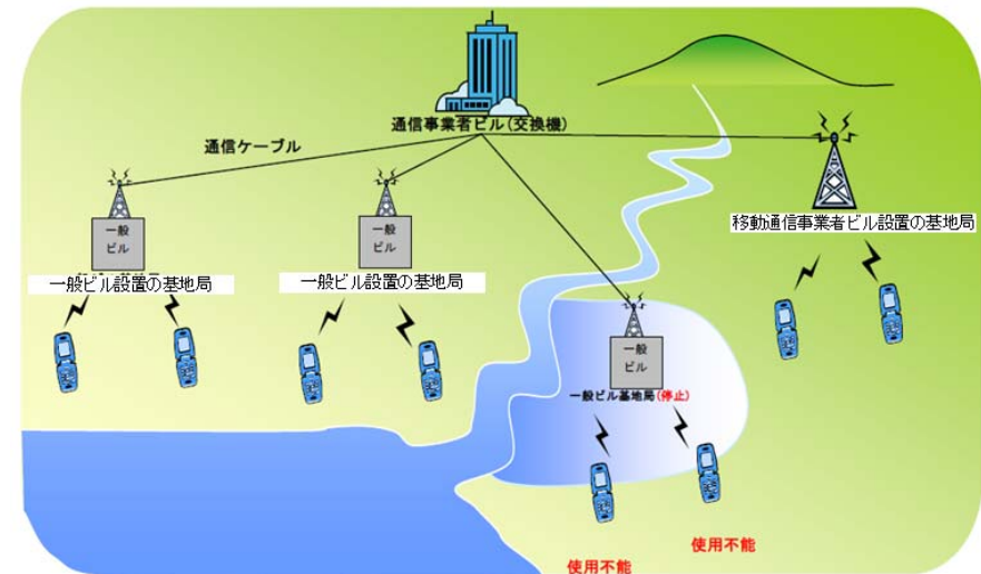
浸水による携帯電話への影響概念図(一部加筆) (出典:国土交通省「水害の被害指標分析の手引」(H25 試行版))
