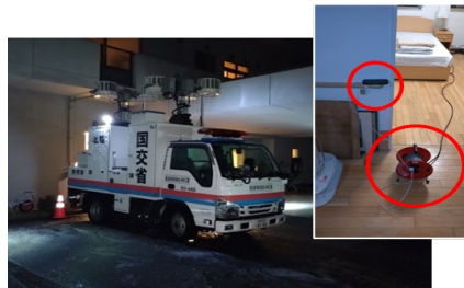
家電製品(スマートフォン)に電力供給 (珠洲市 第三長寿園)
