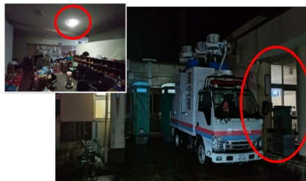
電源供給により停電を解消 (珠洲市 旧本小学校)
