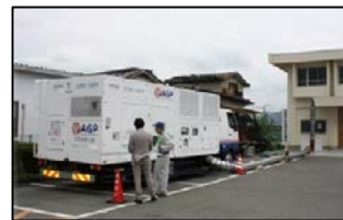
エアコン車による冷暖気供給
