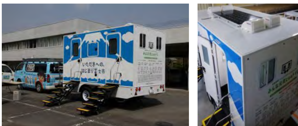
図表6 設置時のトイレトレーラー（左）、天井部のソーラーパネル（右）
