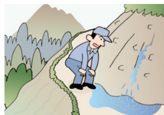
③斜面から水が噴き出す
