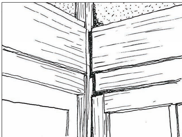
柱と梁の仕口にずれが生じている。
