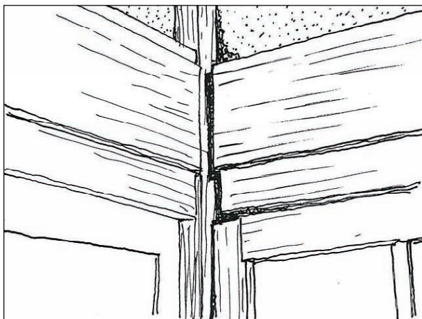
柱と梁の仕口にずれが生じている。
