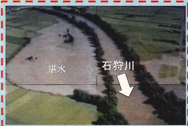
無堤部より溢水:約120ha、6戸の浸水
