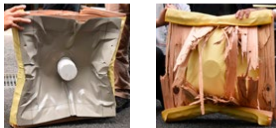
図2 アラミド繊維による補強の効果 「こぶし大」程度の噴石の衝突を高機能繊維により補強された屋根で衝撃吸収
