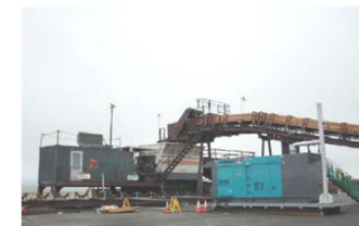
路上に放置された災害廃棄物(水害) 混合物を処理する破碎・選別機
